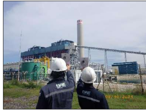
รูปที่ 3-7 การติดตามตรวจสอบค่าความทึบแสงของเขม่าควัน ที่ระบายออกจากปล่องระบายนสารของโรงไฟฟ้า หน่วยผลิตที่ 2 เมื่อวันที่ 9 ตุลาคม พ.ศ. 2567
