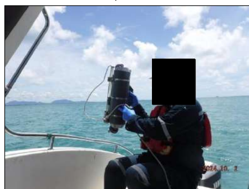
รูปที่ 3-29 การเก็บตัวอย่างน้ำทะเลที่ระยะ 500 เมตร จากจุดระบายน้ำหล่อเย็นของโครงการฯ เมื่อวันที่ 2 ตุลาคม พ.ศ. 2567
