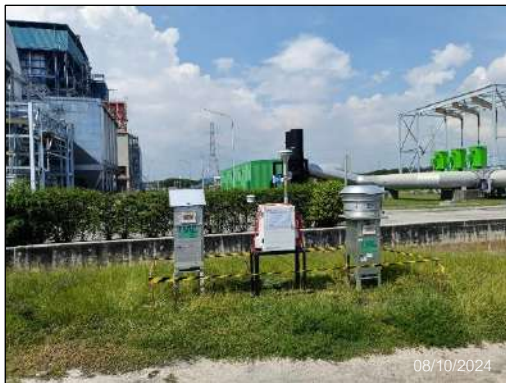
รูปที่ 3-8 การติดตามตรวจสอบคุณภาพอากาศ ในบรรยากาศโดยทั่วไป ทิศเหนือ (บริเวณตะวันออกเฉียงเหนือของลานกองถ่านหิน) ระหว่างวันที่ 8-11 ตุลาคม พ.ศ. 2567
