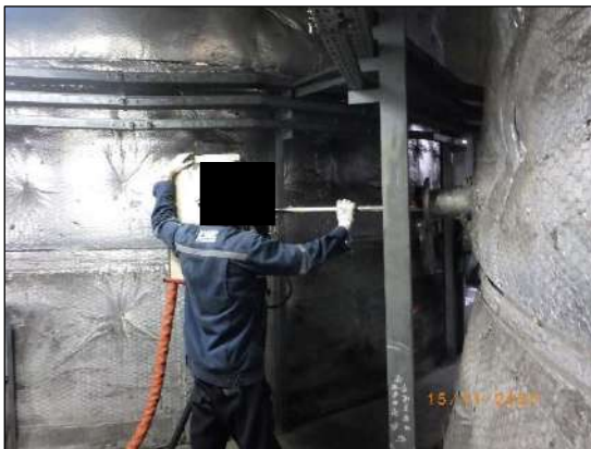
รูปที่ 3-4 การติดตามตรวจสอบปริมาณของสารเจือปนในอากาศที่ระบายออกจากปล่องระบายมลสารของโรงไฟฟ้า หน่วยผลิตที่ 1 เมื่อวันที่ 15 พฤศจิกายน พ.ศ. 2567
